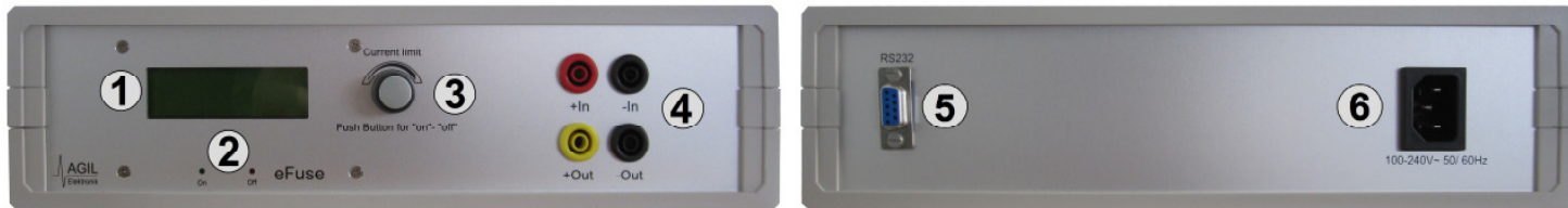
Bild 6.1: Vorder- und Rückansicht der eFuse
